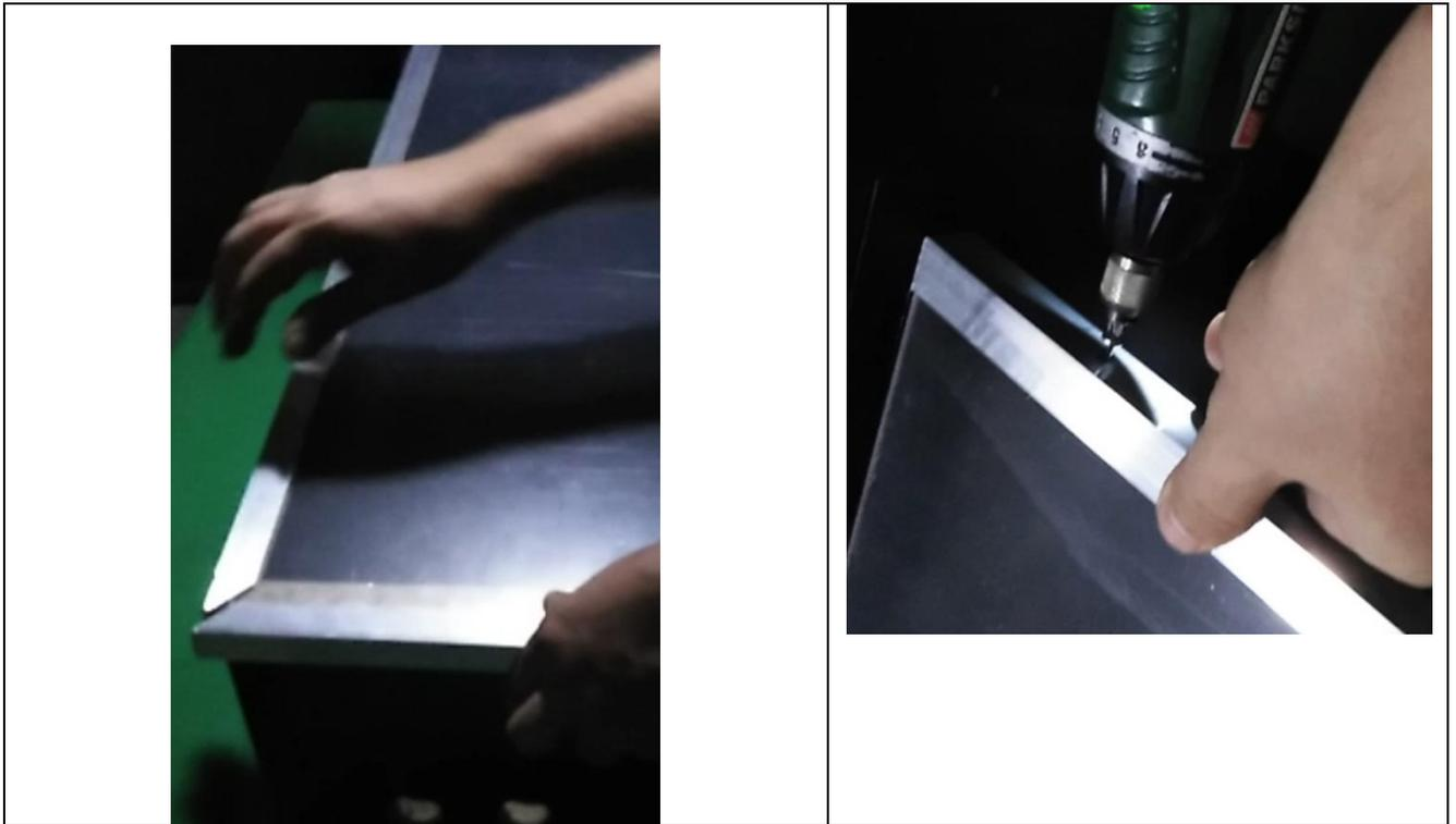
Positionnez les barres aluminium et utilisez les vis dans les trous pré-percés des barres.
